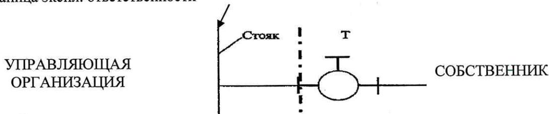
**2. По системе водоотведения:** точка присоединения отводящей трубы системы водоотведения квартиры к тройнику транзитного стояка общедомовой системы водоотведения. Тройник транзитного канализационного стояка и сам стояк обслуживает Управляющая организация, оставшаяся часть – Собственник
