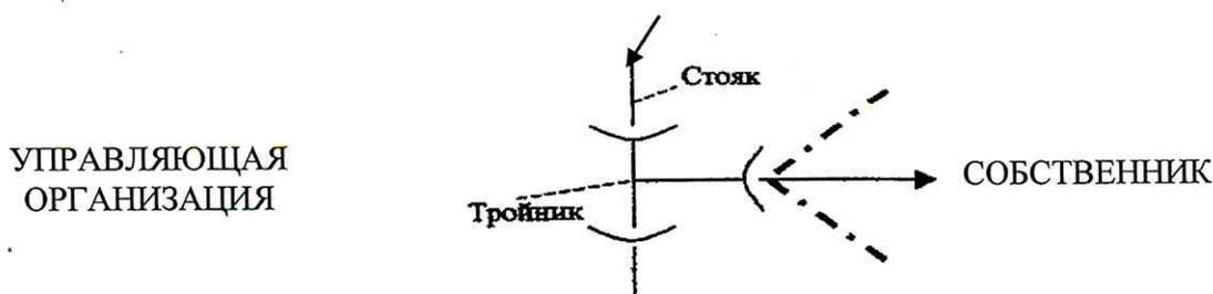
**3. По системе теплоснабжения:** первые точки присоединения подводящих и отводящих труб системы теплоснабжения дома, находящиеся за пределами или внутри помещения, к оборудованию, обслуживающему помещение, принадлежащее Собственнику.
