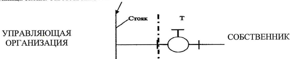
**2. По системе водоотведения:** точка присоединения отводящей трубы системы водоотведения квартиры к тройнику транзитного стояка общедомовой системы водоотведения. Тройник транзитного канализационного стояка и сам стояк обслуживает Управляющая организация, оставшаяся часть – Собственник
