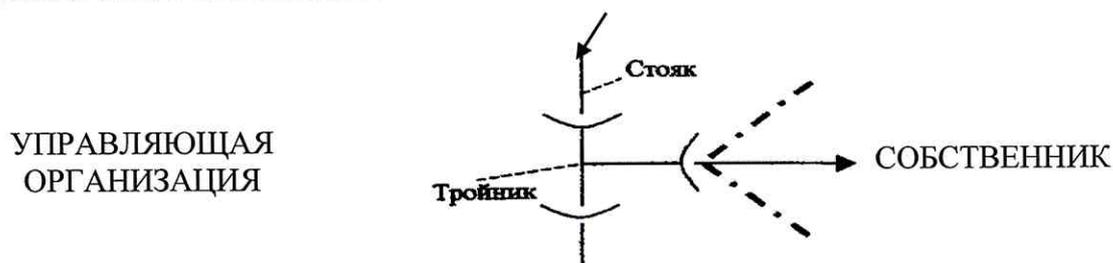
**3. По системе теплоснабжения:** первые точки присоединения подводящих и отводящих труб системы теплоснабжения дома, находящиеся за пределами или внутри помещения, к оборудованию, обслуживаемому помещением, принадлежащее Собственнику.
