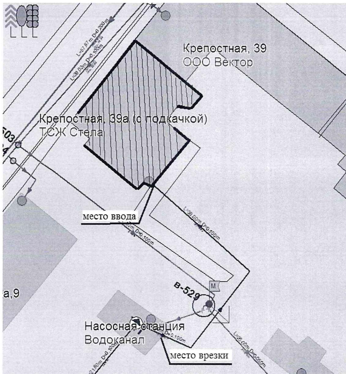
Диаметр ввода в здание 100 мм
