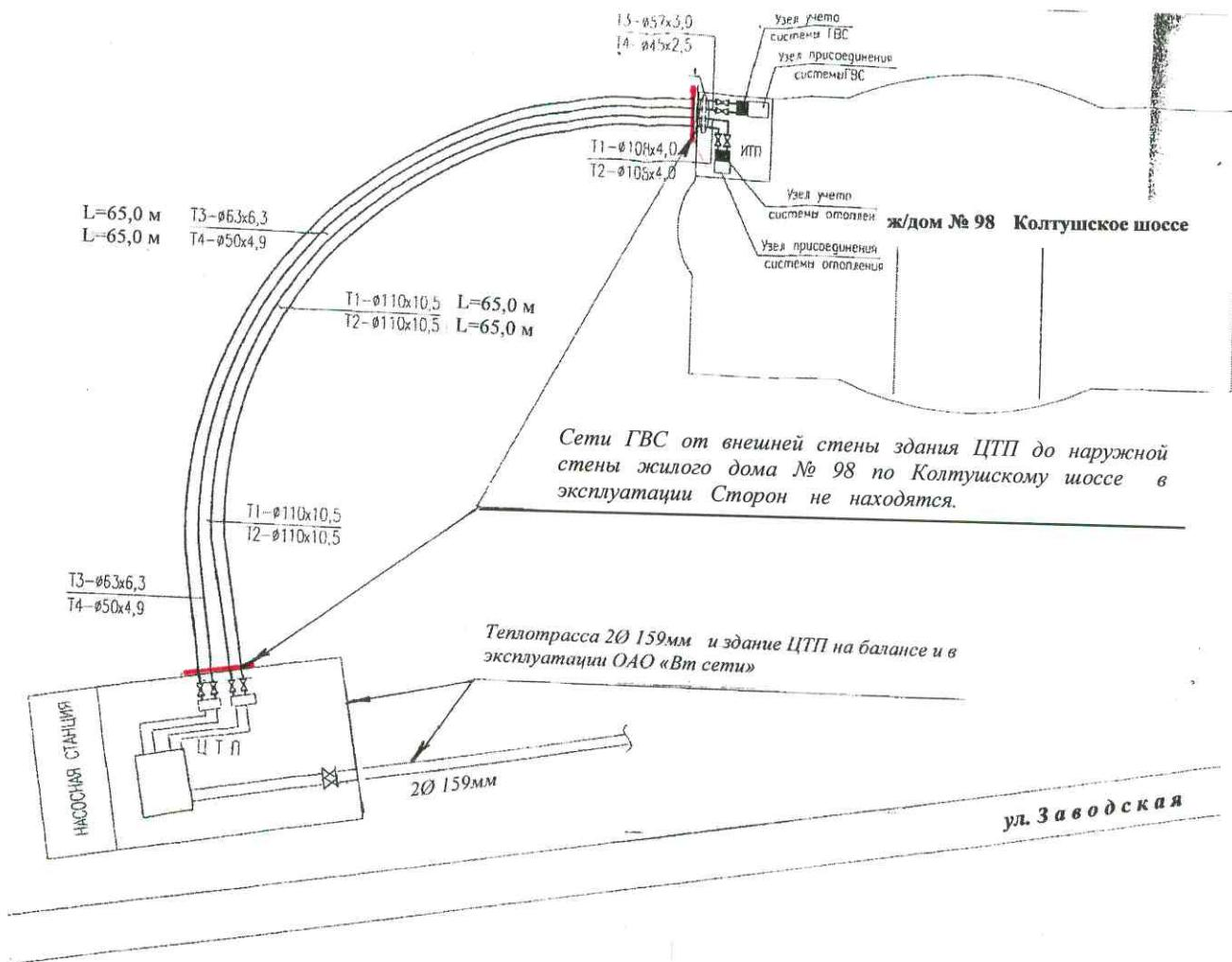
Границы эксплуатационной ответственности по сетям горячего водоснабжения
